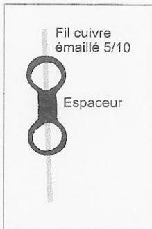
de ce matériaux. Il s'agit de deux "tubes de 5 mm, séparés par une lame de 4mm ; l'ensemble faisant 13mm de large.
