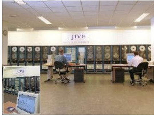
La salle de contrôle du système de corrélation JIVE aux Pays-Bas. Les données recueillies par chaque radiotélescope sont stockées sur les bandes situées à l'arrière-plan. L'ordinateur dispose d'une puissance CPU égale à 16 TFlops. Document Institut JIVE.
