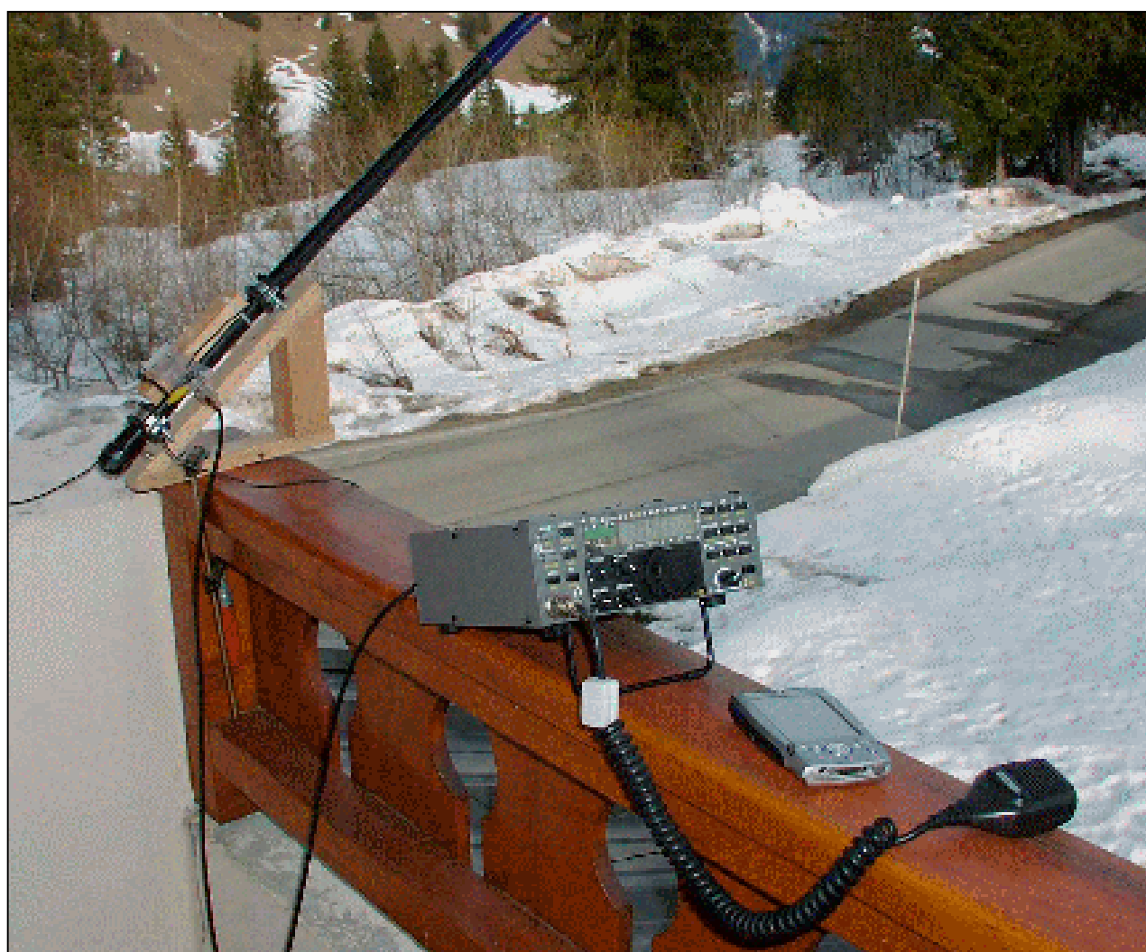
Autre vue de l'installation. L'appareil entre le micro et le TRX est un Pocket PC. Il peut servir à des quantités de choses dans le domaine OM : log-book, database DXCC, terminal RTTY, SSTV et PSK31 , etc. tout en ne tenant pas plus de place qu'une calculette.
