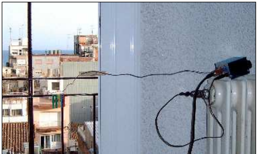
L'aérien et son coupleur. Une pince à linge dans laquelle une encoche a été taillée écarte le fil de l'antenne du montant de porte en aluminium.
