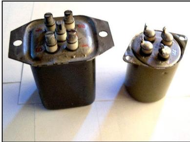
deux transformateurs BF professionnels entièrement blindés. Vous en trouverez dans les anciens appareils militaires et les appareils de mesure. Ces exemplaires-ci se placent à la sortie d'un amplificateur BF à lampe pour attaquer un haut-parleur ou une ligne 600 ohms. Leur taille est petite : le cylindrique à droite a la taille d'une boîte de film. Pourtant, il tient un watt !
