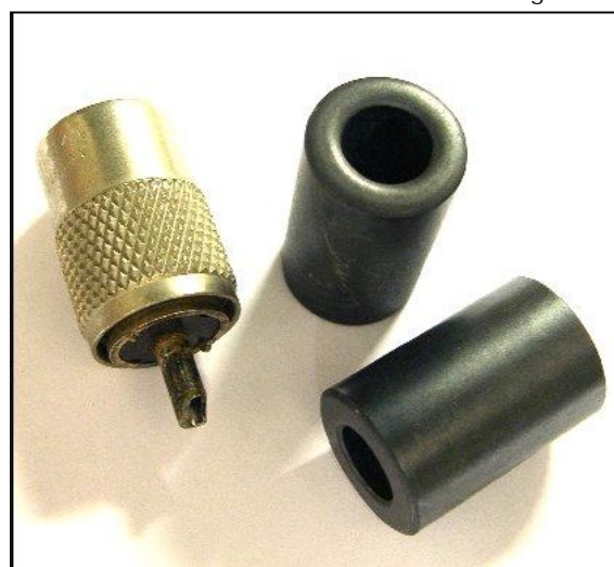
Les tubes en ferrite comparés à une PL259.
