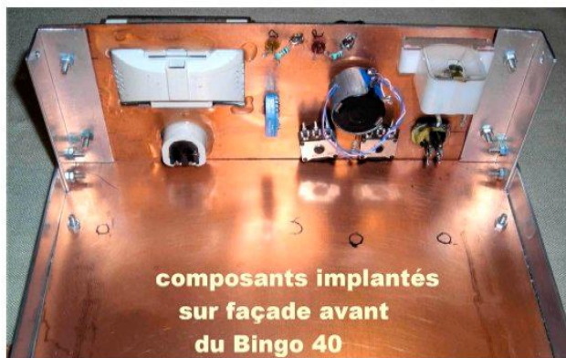
La partie cuivre est tournée vers l'intérieur assurant un parfait plan de masse
