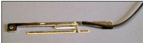
Quelques OM ont trouvé dont Bauduin ON6TB. C'est une antenne WiFi ; donc sur le bord de notre bande des 13cm. C'est un dipôle avec un avec un stub d'adaptation. Les œillets aux extrémités servent à la fixation. Le minuscule coax aurait dû vous mettre la puce à l'oreille...
