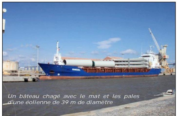
Un bateau chargé avec le mat et les pales d'une éolienne de 39 m de diamètre
