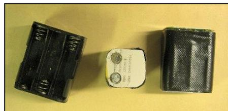
Deux packs réalisés de toutes pièces. A gauche, un boîtier-support de piles standard, au centre, un pack de 4 accus et à droite, un pack de 6 accus. Ils ont été enrobés de toile isolante et les fonds ont été taillés dans des cartes de banque périmées. Deux trous permettent le passage des ressorts de contact. Ces packs sont destinés à un Kenwood TR-2300 (transceiver 2m portable des années '70)
