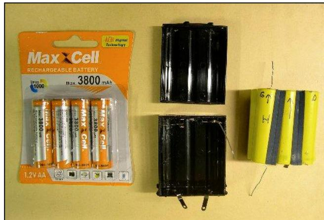
Le départ. De gauche à droite : les nouveaux accus, le boîtier de batterie ouvert et le pack de batteries usagées
