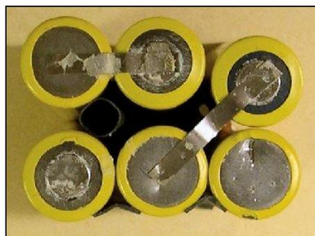
*Le bloc d'accus d'origine. On peut voir la méthode de soudure des languettes. On peut aussi constater la poudre blanche apparaissant au fond des éléments.*
