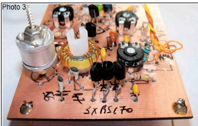
Détails de la construction du VFO le bobinage est 5 mm au dessus du circuit ; à noter les 3 BS170 en //
