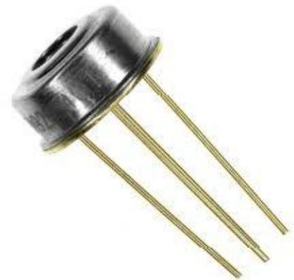
Melexis entend réduire cet effet de 2 ordres de magnitude à l'aide par « compensation intégrée ». Celle-ci consiste à intégrer un capteur secondaire pour mesurer les perturbations thermiques et compenser le résultat de la mesure grâce à une électronique numérique interne.
