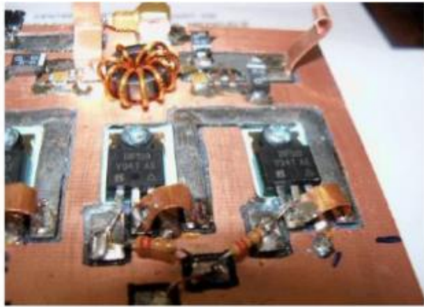
La continuité du Drain au circuit imprimé est assurée par un morceau de feuillard de cuivre en U inversé de 4 à 5 mm de largeur
