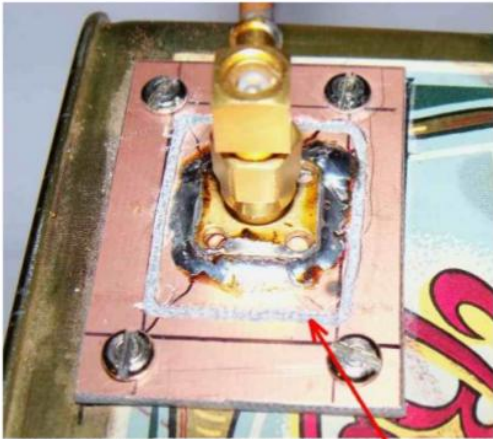
Détourage à la fraise pour isolation
